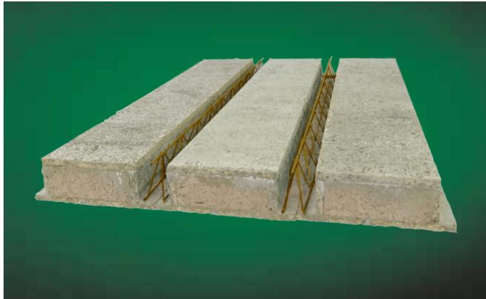
Strop VELOX je lehká variabilní konstrukce zhotovená přímo na stavbě. Strop tvoří stropní prvky VELOX, stropní nosníky, betonářská výztuž a monolitická zálivka s nadbetonávkou z betonu C20/25.
